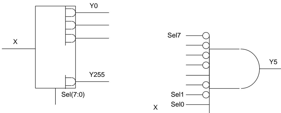
Abbildung 46: Demultiplexer mit AND-Gates
