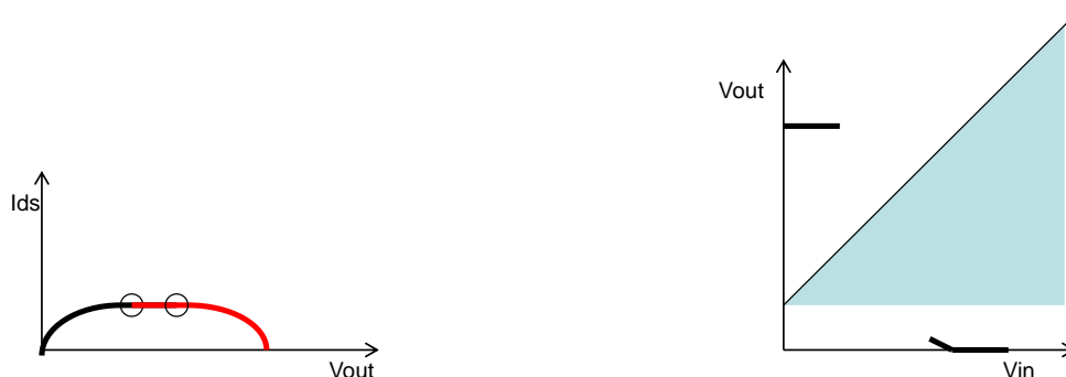
Abbildung 31 Links: Ausgangskennlinien von zwei Transistoren. Rechts: Kennlinie des Inverters. Die graue Fläche zeigt den Sättigungsbereich für PMOS.
