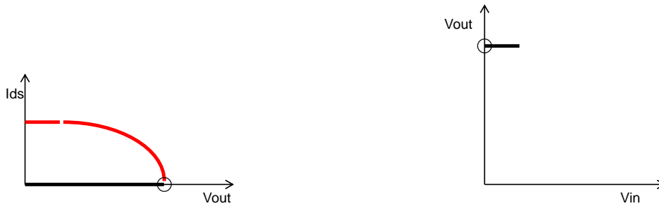
Abbildung 27: Links: Ausgangskennlinien von zwei Transistoren. Rechts: Kennlinie des Inverters. V_{in} < V_{th} .
